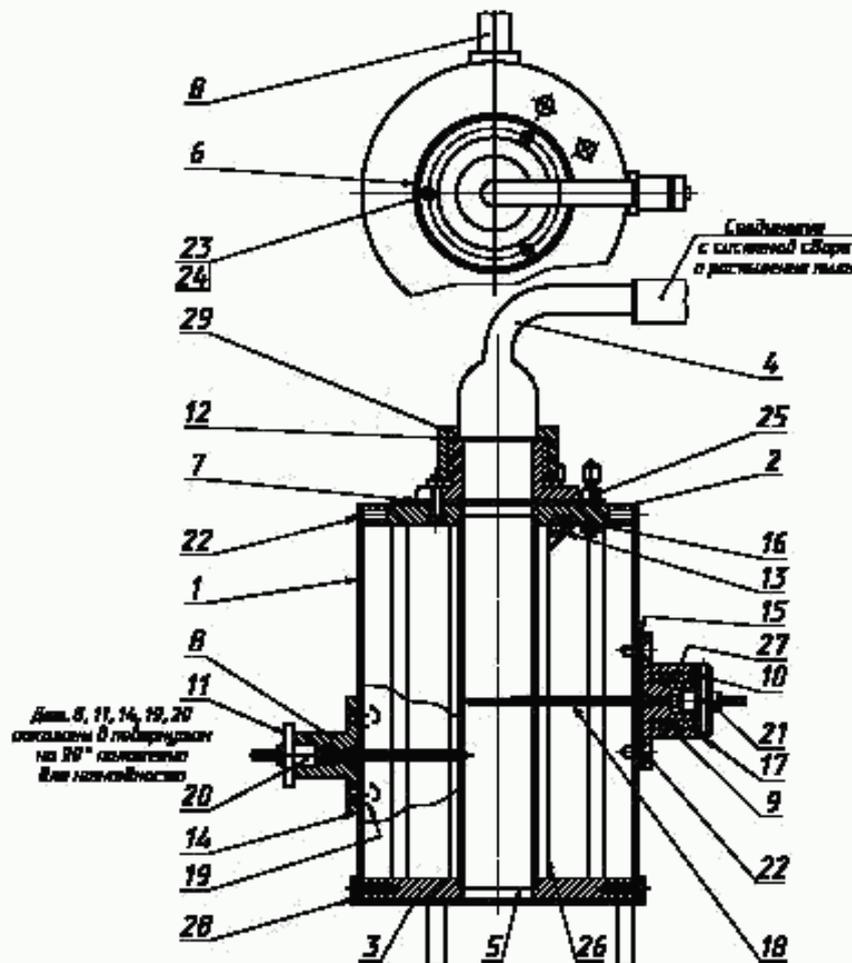
Изоляция для дет. 5: слой глиноземного наполнителя толщиной 5 мм, слой минерального волокна толщиной 25 мм, слой глиноземного наполнителя толщиной 10 мм, остальное — кизельгур.
