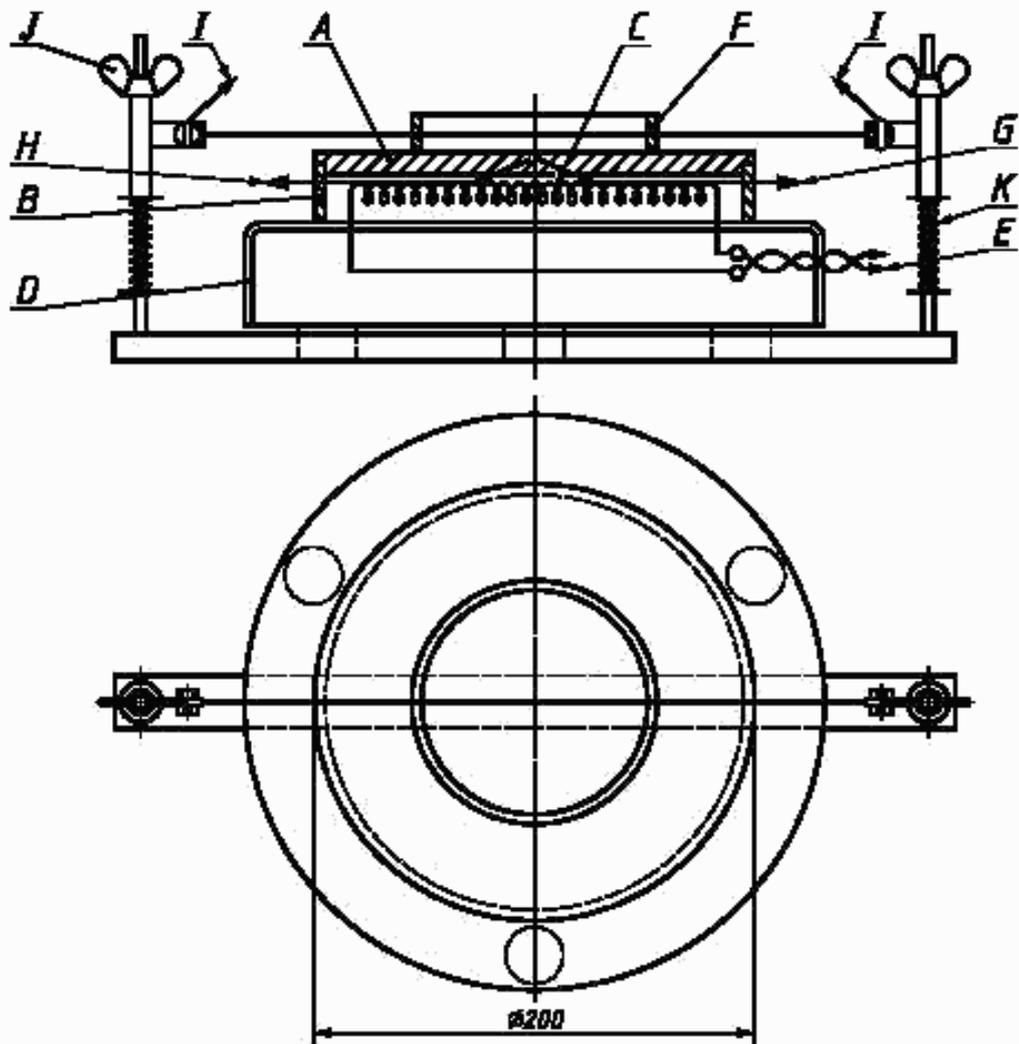
*A* — нагреваемая пластина; *B* — «юбка»; *C* — нагреватель; *D* — основание нагревателя; *E* — соединение нагревателя с источником питания и контроллером; *F* — кольцо для слоя пыли; *G* — соединение контрольной термопары пластины с контроллером; *H* — соединение регистрирующей термопары пластины с прибором; *I* — соединение термопары, регистрирующей температуру в слое пыли, с прибором; *J* — винт регулировки высоты термопары; *K* — спиральная пружина
