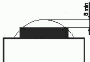
Рисунок А.1с — Чрезмерный слой пыли на стенах оборудования
