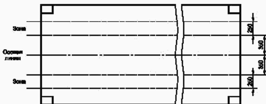
Рисунок Б.1 — Размеры зон в продольном направлении
