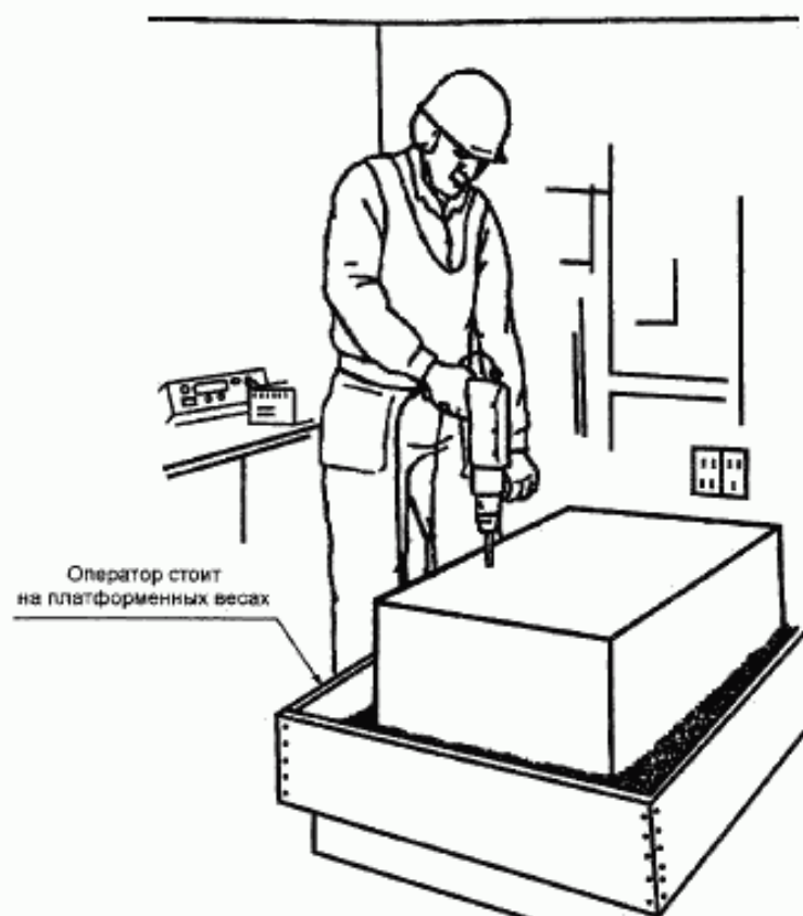
Рисунок 2 — Рабочее положение оператора при испытании бурильных молотков
