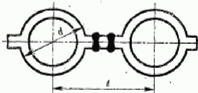
$d$ —наружный диаметр трубы;  $l$ —расстояние
