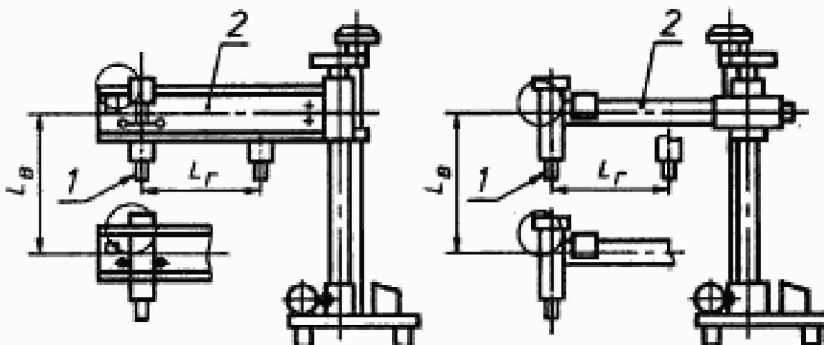
1 — сварочный автомат, 2 — консоль;  $L_r$  — горизонтальный ход консоли или сварочного автомата вдоль оси консоли;  $L_h$  — вертикальный ход консоли
