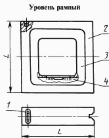
1 — поперечная ампула; 2 — корпус; 3 — термозоляционная накладка; 4 — продольная ампула
