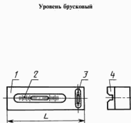
1 — термозоляционная накладка; 2 — продольная ампула; 3 — поперечная ампула; 4 — основание
