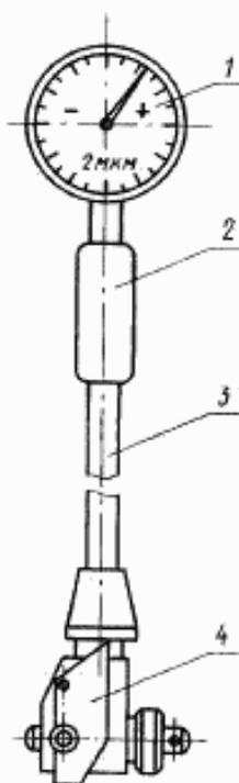
1 — отсчетное устройство; 2 — ручка; 3 — корпус;
