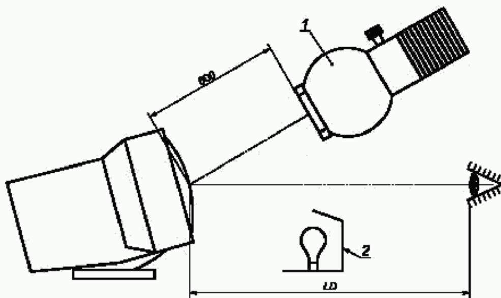
1 — источник зеркального отражения; 2 — вспомогательный источник освещения экрана.
