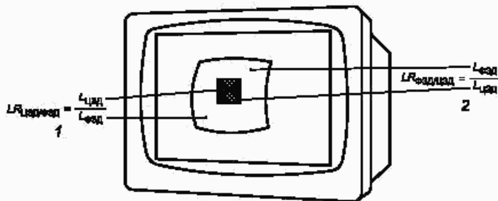
1 — при отрицательной полярности; 2 — при положительной полярности
