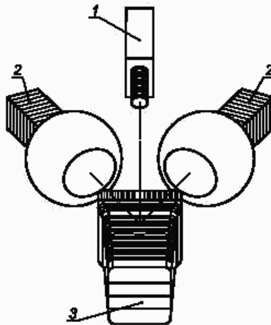
1 — точечный фотометр; 2 — протяженный источник яркости; 3 — испытуемый ВДТ
