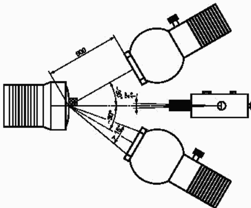
Рисунок 9 — Измерения диффузно отраженного излучения
