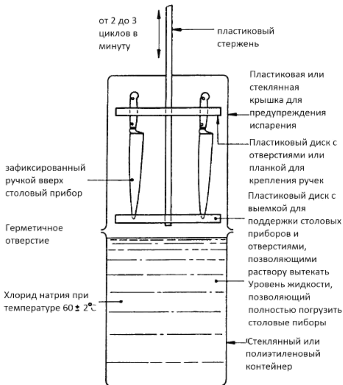
Рисунок А.1 - Оборудование для испытаний на коррозионную стойкость
