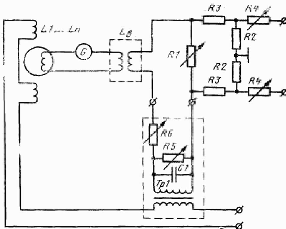
$R_4$  — регулировочное сопротивление;  $C_1$  — емкость;  $T_{01}$  — трансформатор;
