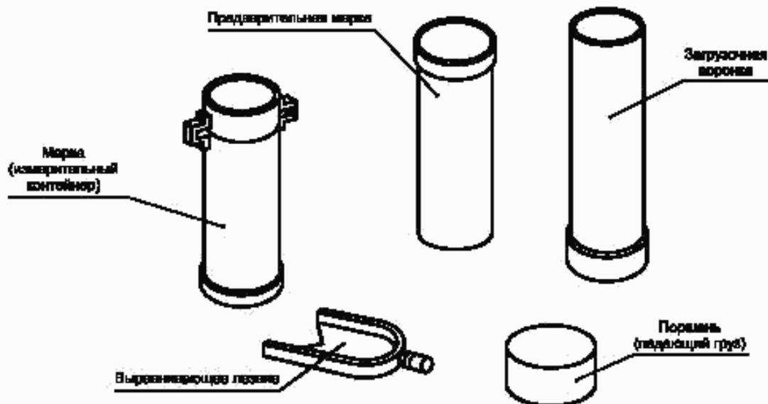
Рисунок 1 — Пурка и ее составные части для определения насыпной плотности зерна с использованием мерки вместимостью 1 дм<sup>3</sup>
