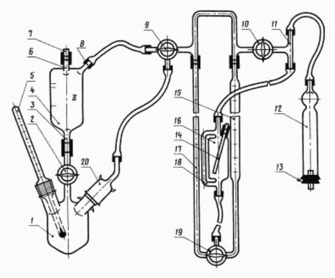
I — сосуд I; 2, 10 — одноходовые краны; 3, 8 — отводы; 4 — сосуд II; 5 — термометр; 6 — трубка для ввода масла;
