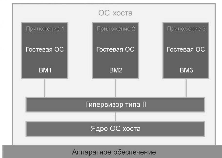
Рисунок 2 — Виртуализация аппаратного обеспечения гипервизором типа II
