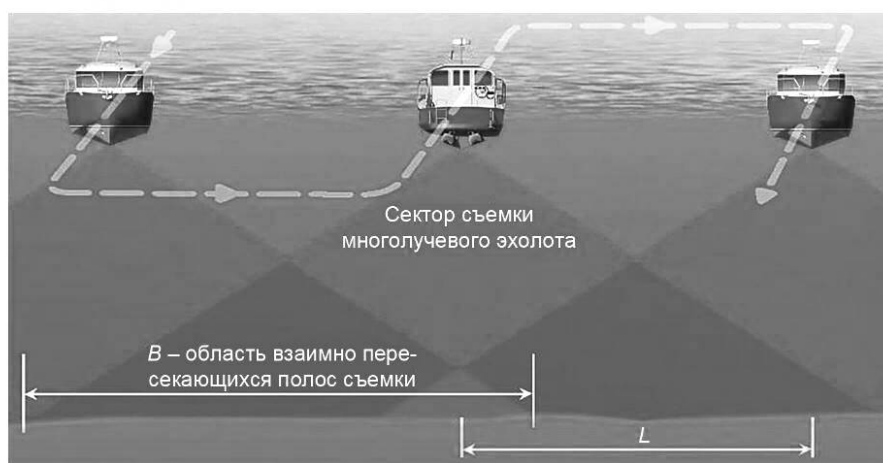
в) Площадное обследование с использованием многолучевого эхолота
