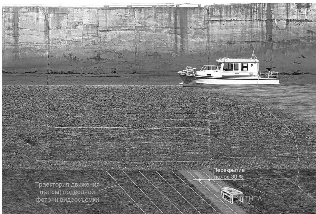
б) Схема выполнения фото- и видеосъемки на горизонтальной поверхности
