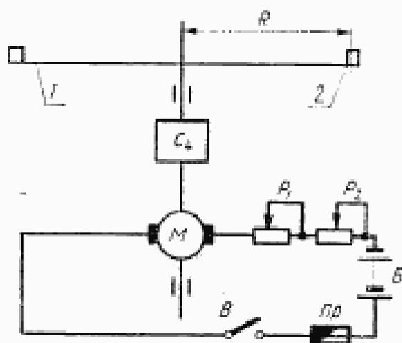
1—крестовина; 2—стойка для крепления анемометров;  $C_4$ —счетчик частоты вращения крестовины;  $M$ —двигатель;  $P_1$ ,  $P_2$ —реостаты;  $B$ —аккумуляторная батарея;  $B$ —выключатель;  $Pr$ —предохранитель.
