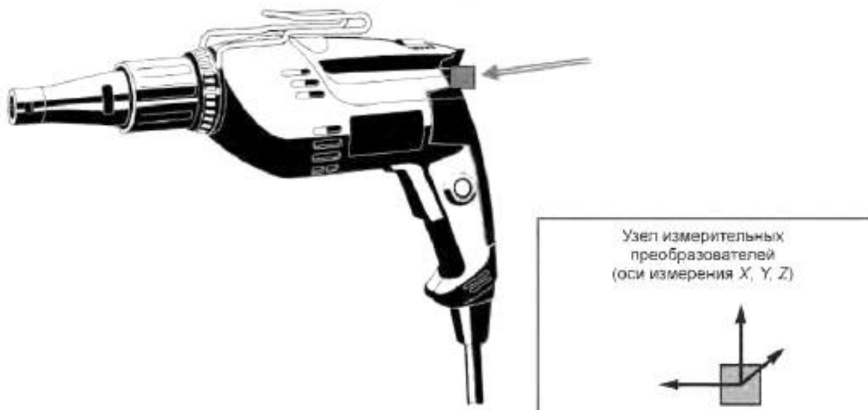
Рисунок I.102 — Место установки измерительного преобразователя для шуруповертов
