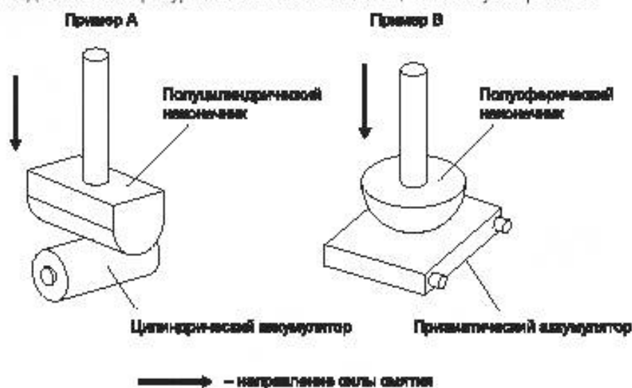
Рисунок 3 — Пример испытания на смятие
