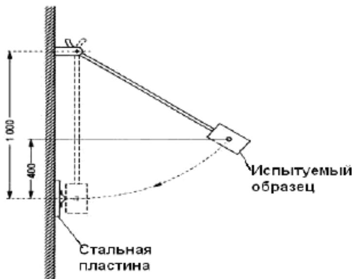
Рисунок 102 – Приспособление для испытания на удар для трансформаторов (см. 16.101)
