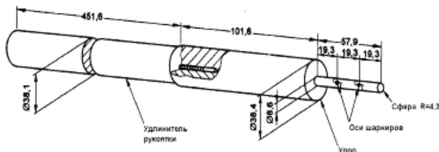
Материал: металл; размеры в миллиметрах, допуски для размеров  $\pm 0,125$  мм.
