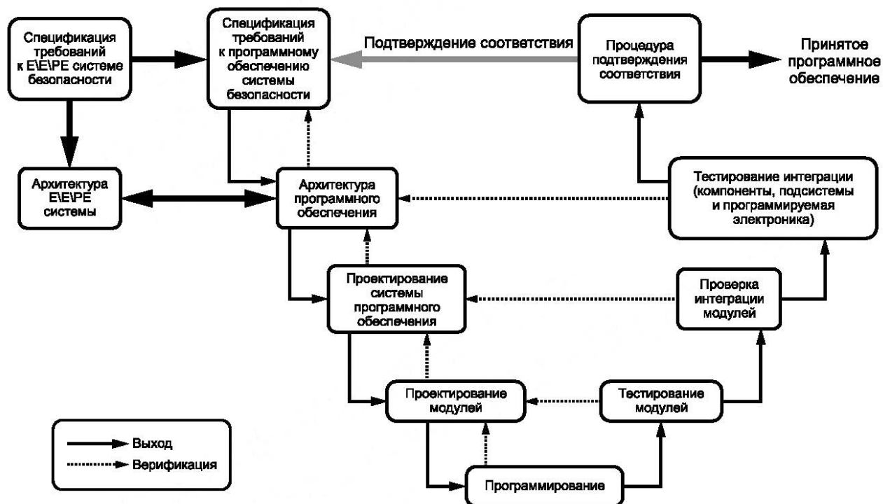
Рисунок 6 — Стойкость к систематическим отказам и жизненный цикл разработки программного обеспечения (V-модель)
