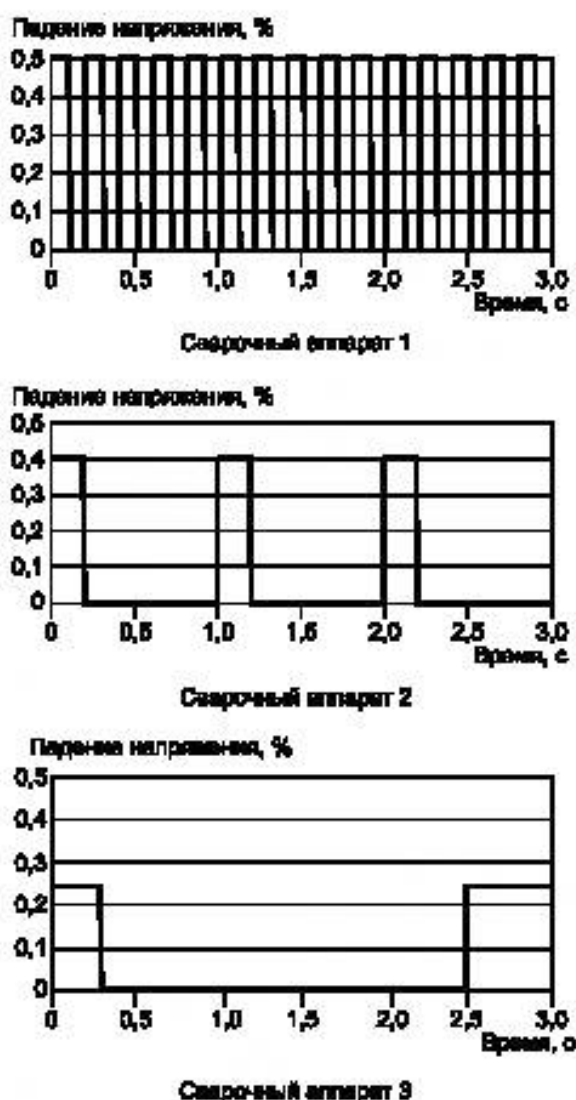
Рисунок G.2 — Пример эффекта многоцелевой сварочной нагрузки
