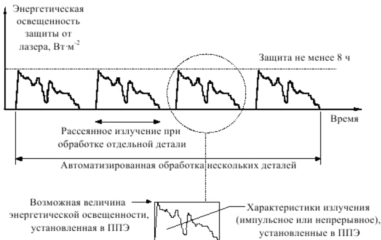
Рисунок В.5 – Пример экспозиции защиты от лазера во время периодически повторяющихся машинных операций
