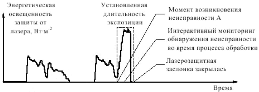
Рисунок В.6а – Отключение лазера при использовании интерактивного машинного мониторинга безопасности
