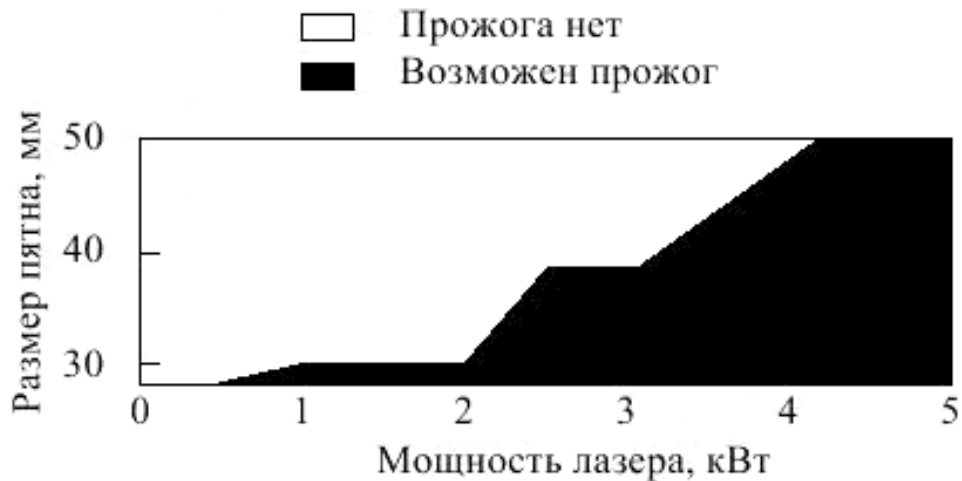
Рисунок F.4 – Стойкость к разрушению листа оцинкованной стали толщиной 2 мм от 100 с экспозиции расфокусированного пучка во время экспериментов с использованием непрерывного лазера на углекислом газе
