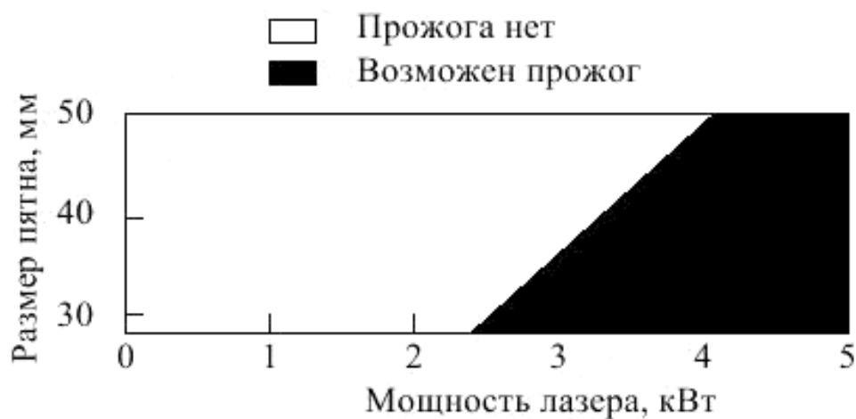
Рисунок F.6 – Стойкость к разрушению листа оцинкованной стали толщиной 3 мм от 100 с экспозиции расфокусированного пучка во время экспериментов с использованием непрерывного лазера на углекислом газе
