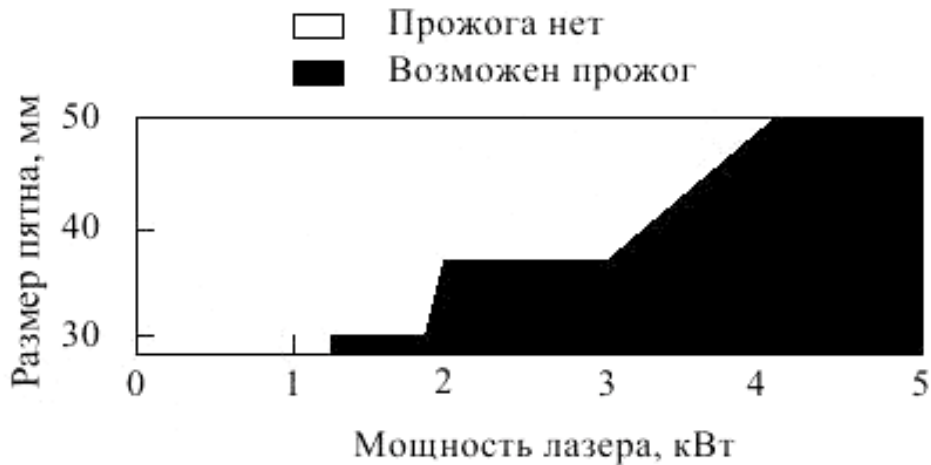
Рисунок F.9 – Стойкость к разрушению листа нержавеющей стали толщиной 1 мм от 10 с экспозиции расфокусированного пучка во время экспериментов с использованием непрерывного лазера на углекислом газе
