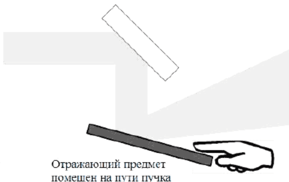
Рисунок В.4d – Отражающий предмет пересекает пучок лазера
