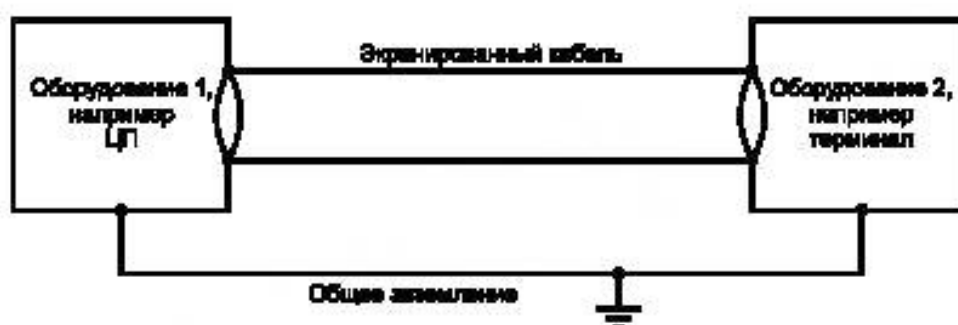
Рисунок R.1 — Пример защиты от перенапряжения с помощью экранирования в зданиях с общими стандартными системами заземления
