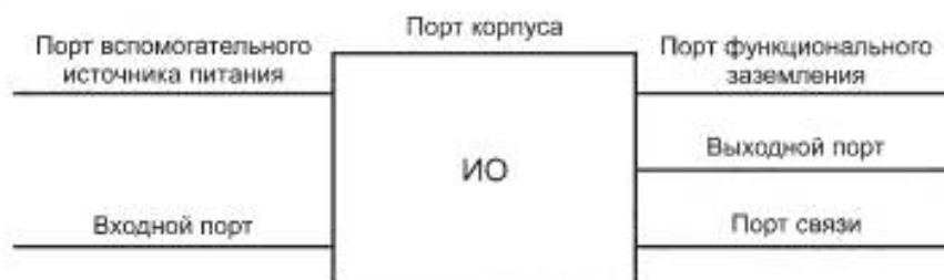
Рисунок 1 — Порты для измерительных реле и защитного оборудования
