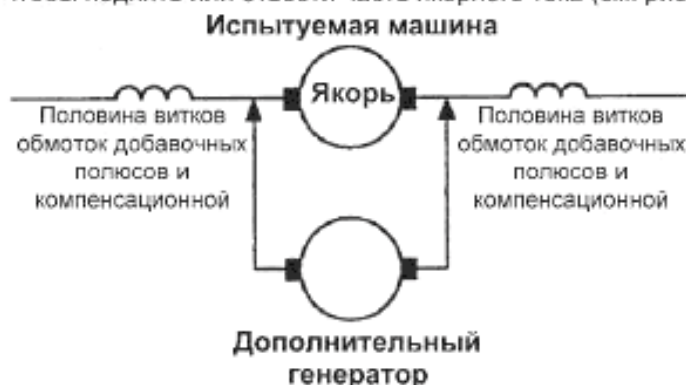
Рисунок 4 – Дополнительный генератор, используемый для увеличения или отведения части тока якоря
