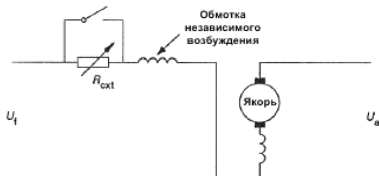
Рисунок 2 – Схема для измерения индуктивности независимой обмотки возбуждения с учетом насыщения
