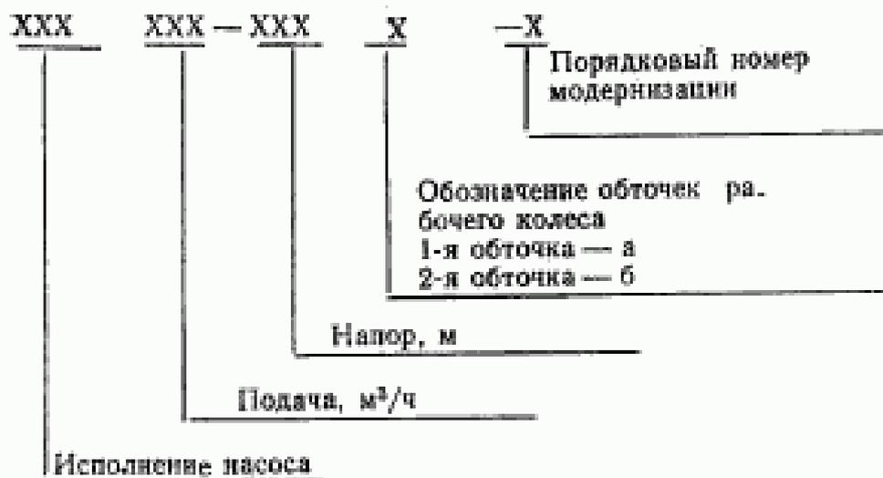
Пример условного обозначения насоса центробежного конденсатного вертикального исполнения с подачей 0,056 м<sup>3</sup>/с (200 м<sup>3</sup>/ч, напором 130 м:
