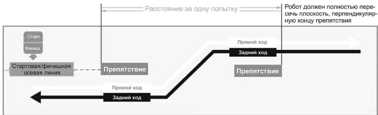
Рисунок 3 — Вид сверху на зигзагообразный маршрут (прямым и задним ходом), определяемый препятствиями
