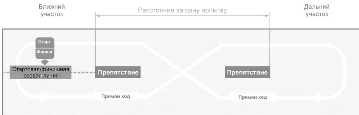
Рисунок 2 — Вид сверху на маршрут движения восьмеркой (прямым ходом), определяемый препятствиями
