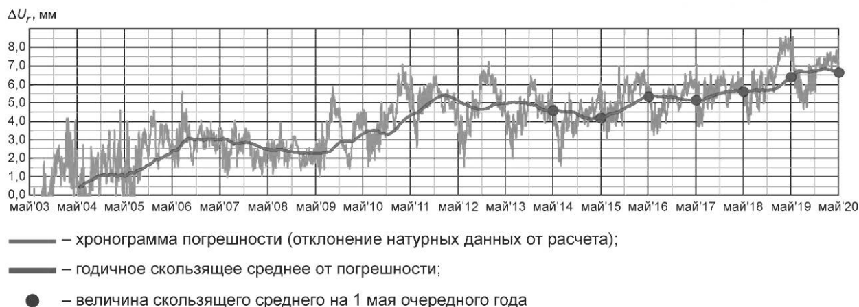
Рисунок Г.1 — Отклонение натуральных данных от расчетных в радиальных перемещениях гребня центральной секции бетонной арочно-гравитационной плотины, мм
