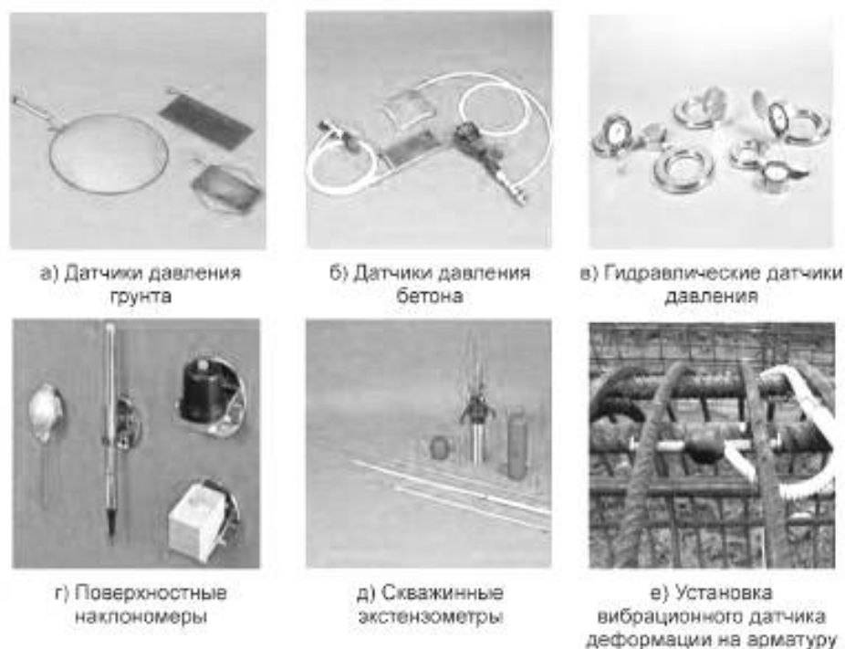
Рисунок 13 — Примеры датчиков для мониторинга строительных конструкций объекта
