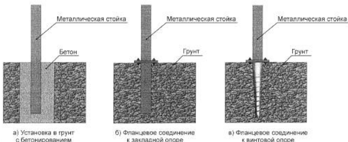
Рисунок 6 — Способы установки опор основного ограждения на точечный фундамент
