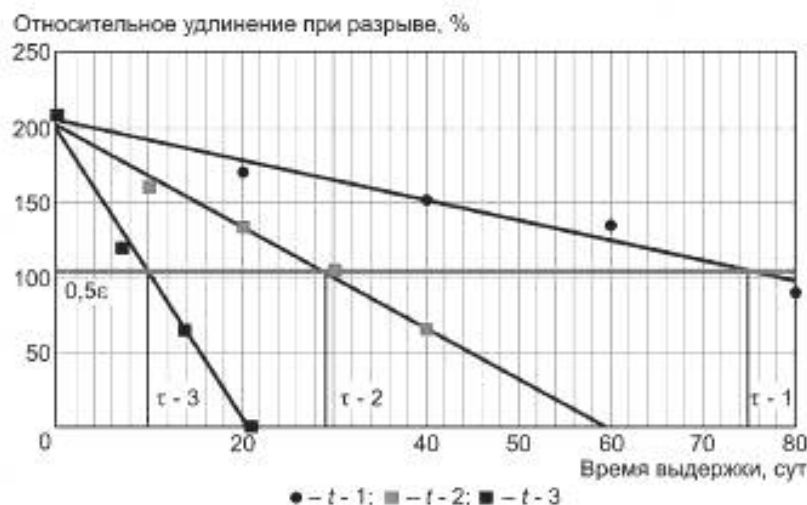
Рисунок 1 — Пример условного графика зависимости относительного удлинения при разрыве при установленных температурах испытаний от продолжительности старения
