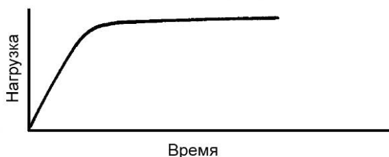
а) Нереверсивная динамическая нагрузка (например, открытие клапана)
