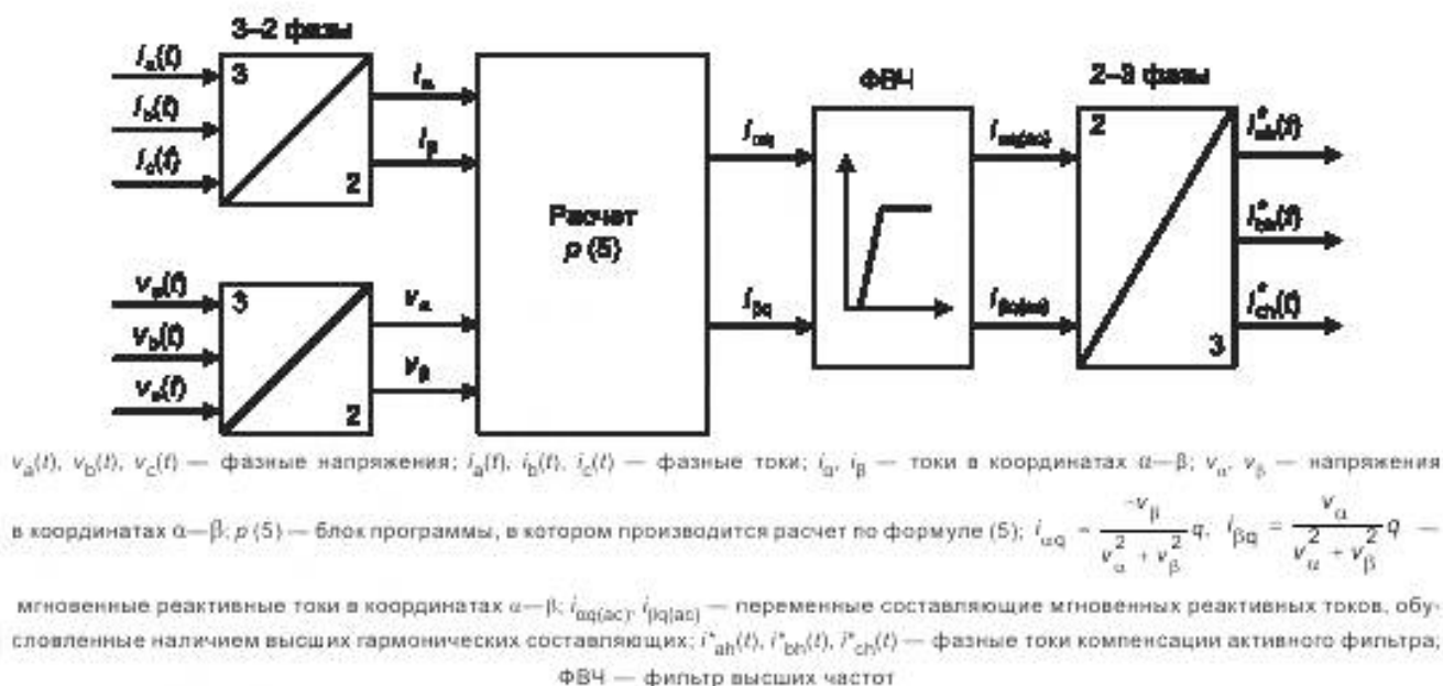
Рисунок 9 — Схема алгоритма метода мгновенной реактивной мощности
