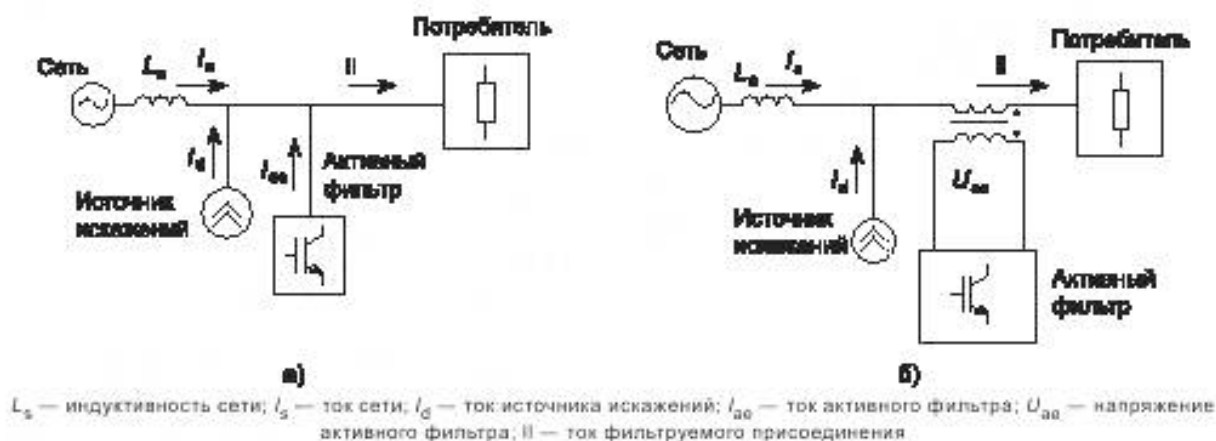
Рисунок 3 — Подключение параллельного и последовательного активного фильтра
