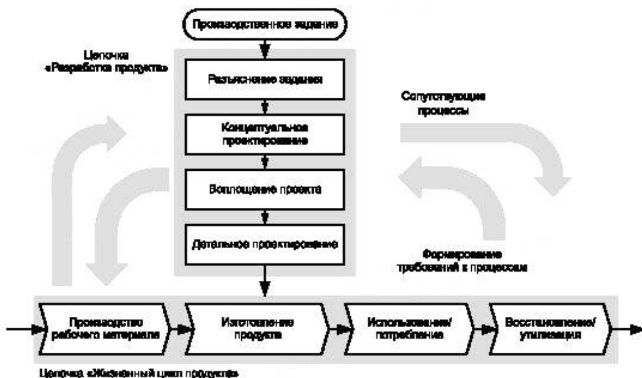
Рисунок 7 — Связь между цепочкой «Разработка продукта» и цепочкой «Жизненный цикл продукта»
