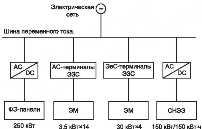
Рисунок 9 — Пример принципиальной схемы бытовой ЭЗС-ФЭ-СНЭЭ на базе общей шины переменного тока
