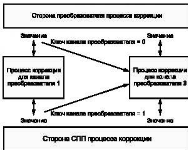
Рисунок 17 — Значение ключа входного канала преобразователя коррекции
