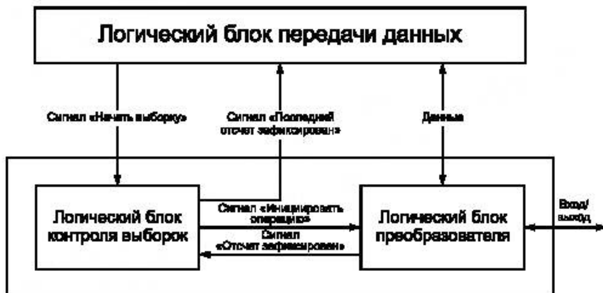
Рисунок 9 — Элементарные функциональные блоки канала преобразователя
