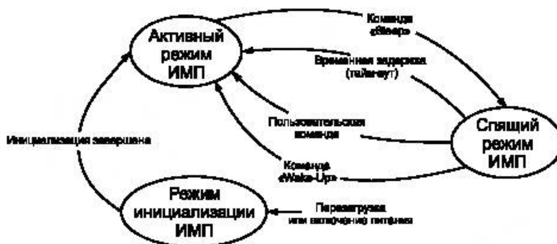
Рисунок 4 — Режимы работы интерфейсного модуля преобразователя
