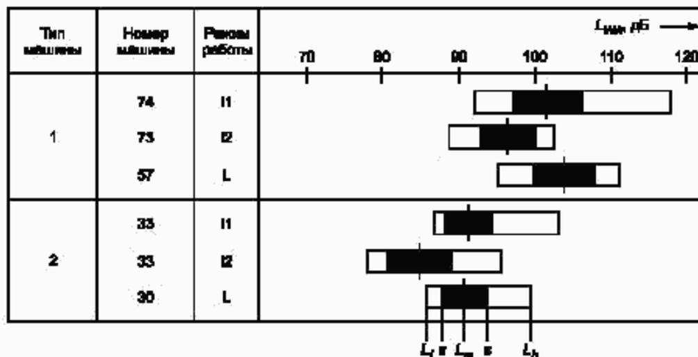
И1 — режим холостого хода при максимальной скорости; И2 — режим холостого хода при номинальной скорости; L — нагрузка при заданном режиме работы с рабочим инструментом;  $s$  — стандартное отклонение;  $L_{\min}$  — наименьший уровень;  $L_m$  — средний уровень;  $L_{\max}$  — наибольший уровень
