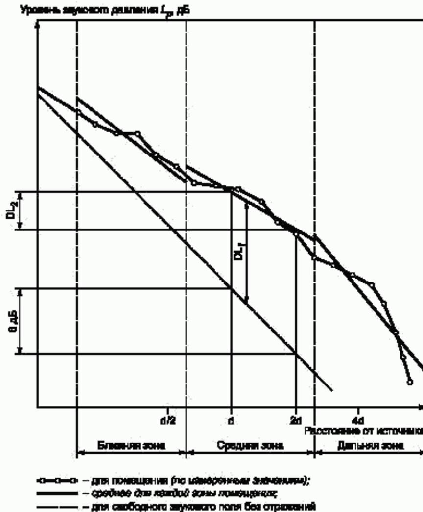
Примечание — На рисунке отмечены три характерные пространственные области (зоны) и значения пространственного сдвига  $DL_2$  и эксцесса  $DL_1$  уровня звукового давления.
