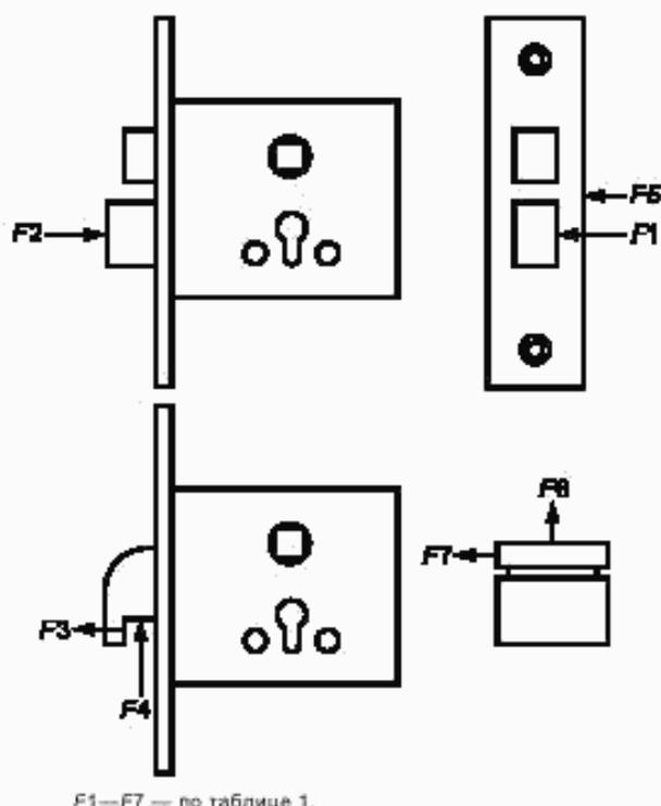
Рисунок 1 — Точки приложения сил, воздействующих на механизм замка
