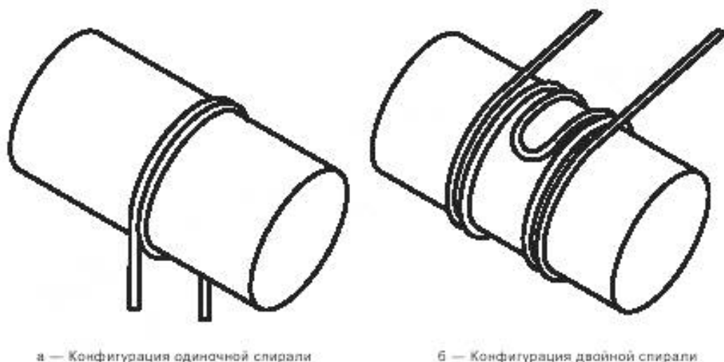
Рисунок 15 — Схема испытания ОК на воздействие статического изгиба
