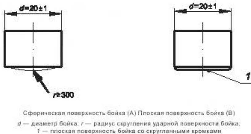
Рисунок 6 — Схема формы бойка ударника
