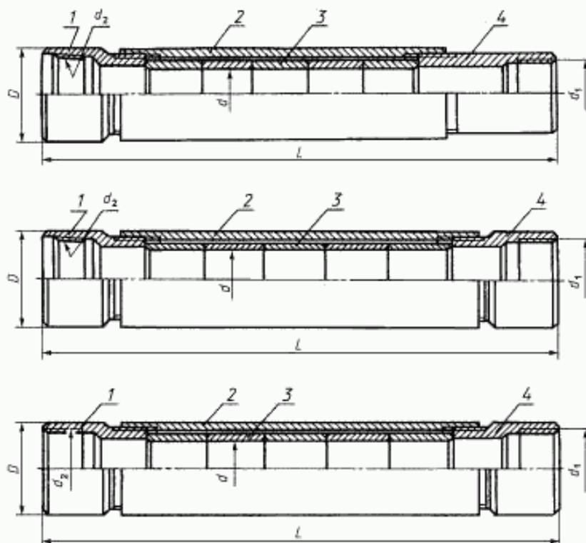
1 — переводник цилиндра; 2 — корпус; 3 — втулки; 4 — переводник удлинителя
