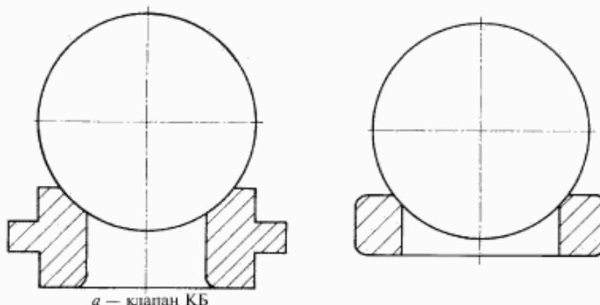
Рисунок 16 — Конструктивное исполнение седел клапанов
