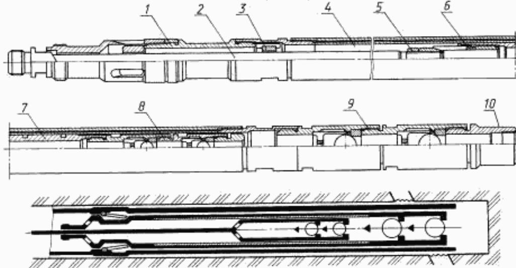
1 — замок и уплотнение насоса; 2 — шток; 3 — упор; 4 — цилиндр; 5 — контргайка; 6 — переводник плунжера;
