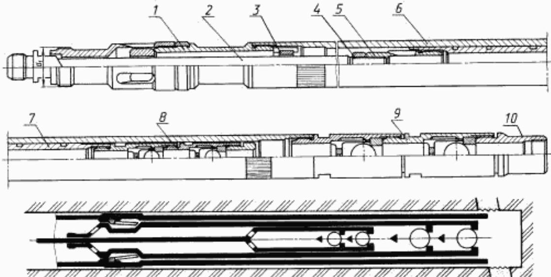
1 — замок и уплотнение насоса; 2 — шток; 3 — упор; 4 — контргайка; 5 — переводник плунжера; 6 — цилиндр; 7 — плунжер;
