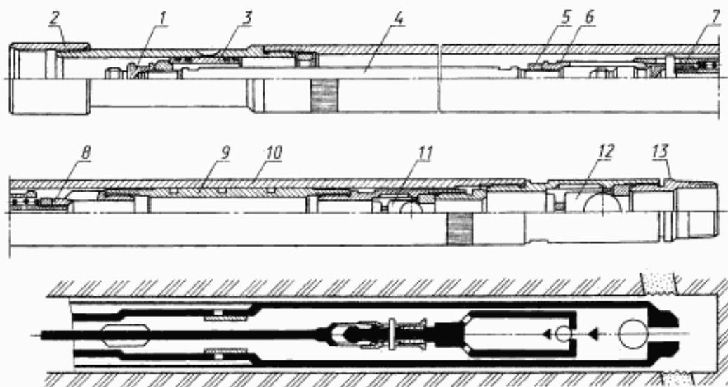
1 — переводник штока; 2 — верхний переводник; 3 — сливное устройство; 4 — шток; 5 — контргайка; 6 — цапговый захват; 7 — нагревающее устройство; 8 — переводник плунжера; 9 — плунжер; 10 — цилиндр; 11 — нагнетательный клапан; 12 — всасывающий клапан; 13 — переводник насоса
