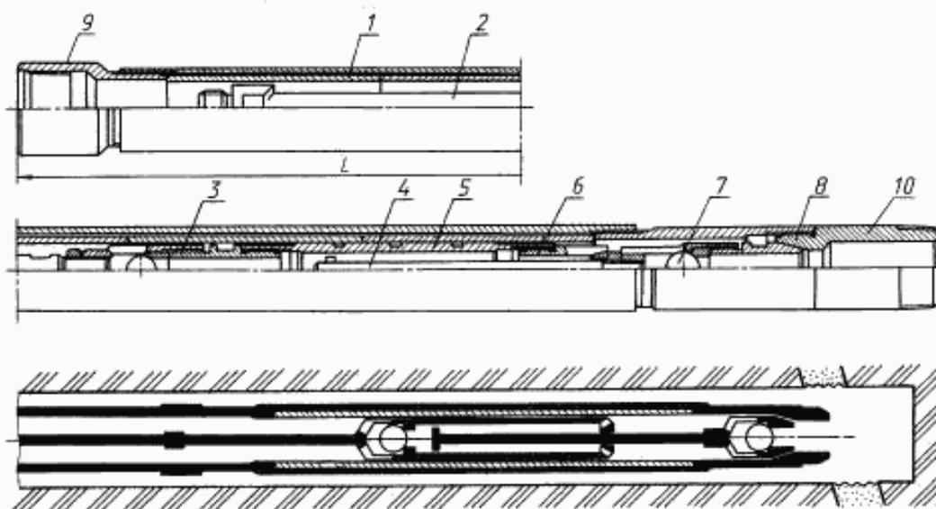
1 — цилиндр; 2 — шток; 3 — нагнетательный клапан; 4 — захватный шток; 5 — плунжер; 6 — наконечник плунжера; 7 — всасывающий клапан; 8 — седло конуса; 9 — опора всасывающего клапана; 10 — верхний переводник
