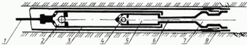
1 — шток; 2 — нагнетательный клапан; 3 — цилиндр; 4 — всасывающий клапан; 5 — плунжер; 6 — патрубок-удлинитель; 7 — упорный штипель с конусом; 8 — насосно-компрессорная труба с замковой опорой
