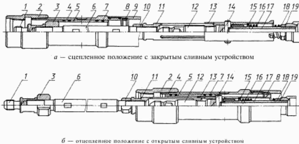
1 — переводник штока; 2 — муфта; 3 — центратор; 4, 17 — патрубки; 5 — золотник; 6 — шток; 7 — резиновое кольцо; 8 — упор; 9 — цилиндр; 10, 18 — коньтрайки; 11 — цапговый захват; 12 — сердечник; 13 — стакан захвата; 14 — вкладыш; 15 — кольцо; 16 — пружина; 19 — клетка плунжера
