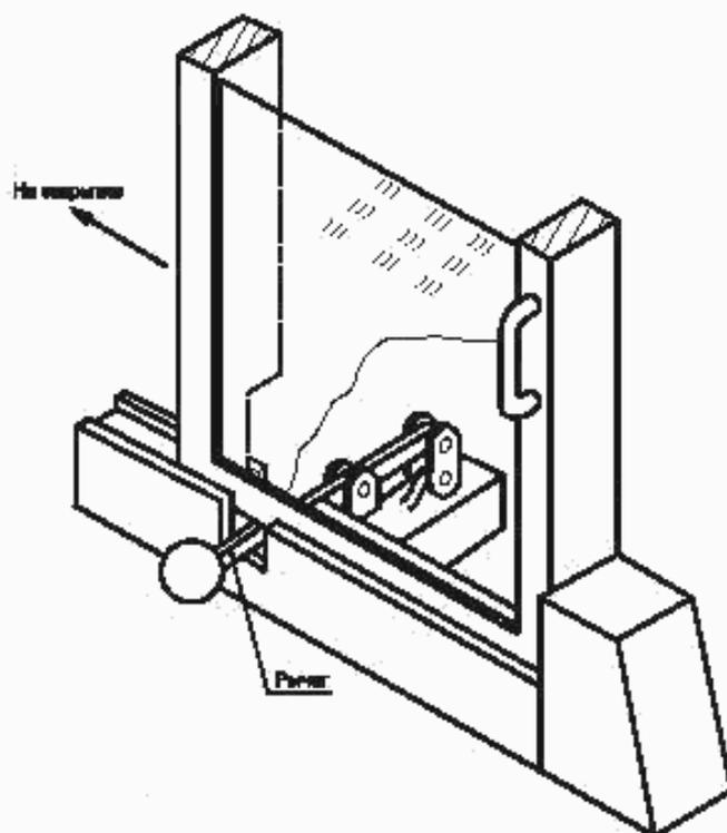
Рисунок С.2 — Защитное устройство открыто
