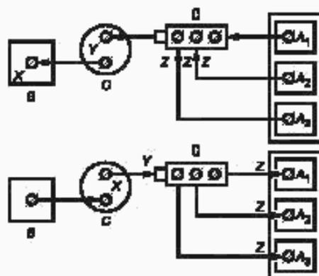
*A* ( $A_1$ ,  $A_2$ ,  $A_3$ ) — замок (замки) на защитном устройстве (устройствах); *B* — замок на элементе прерывания цепи; *X*, *Y*, *Z* — ключи;  $\emptyset$  — замок без вставленного в него ключа;  $\ominus$  — замок со вставленным в него ключом
