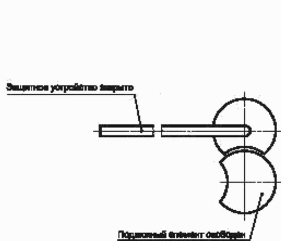
Пока подвижный элемент не остановлен, защитное устройство заблокировано в закрытом положении
