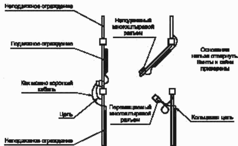
Рисунок F.1 — Шарнирное (поворотное) защитное устройство.
