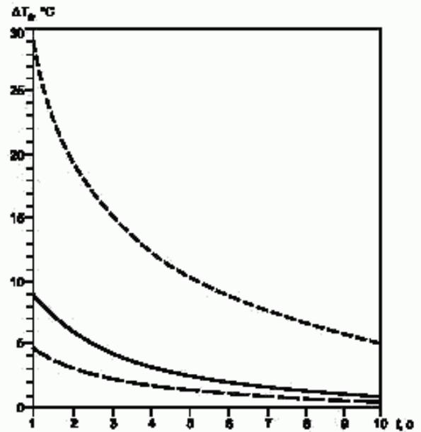
Рисунок 3б — Увеличение ожогового порога, указанного на рисунке 2, для металлической поверхности, покрытой рилсаном толщиной 400 мкм, порошком 60 и 90 мкм и фарфоровой эмалью 160 мкм
