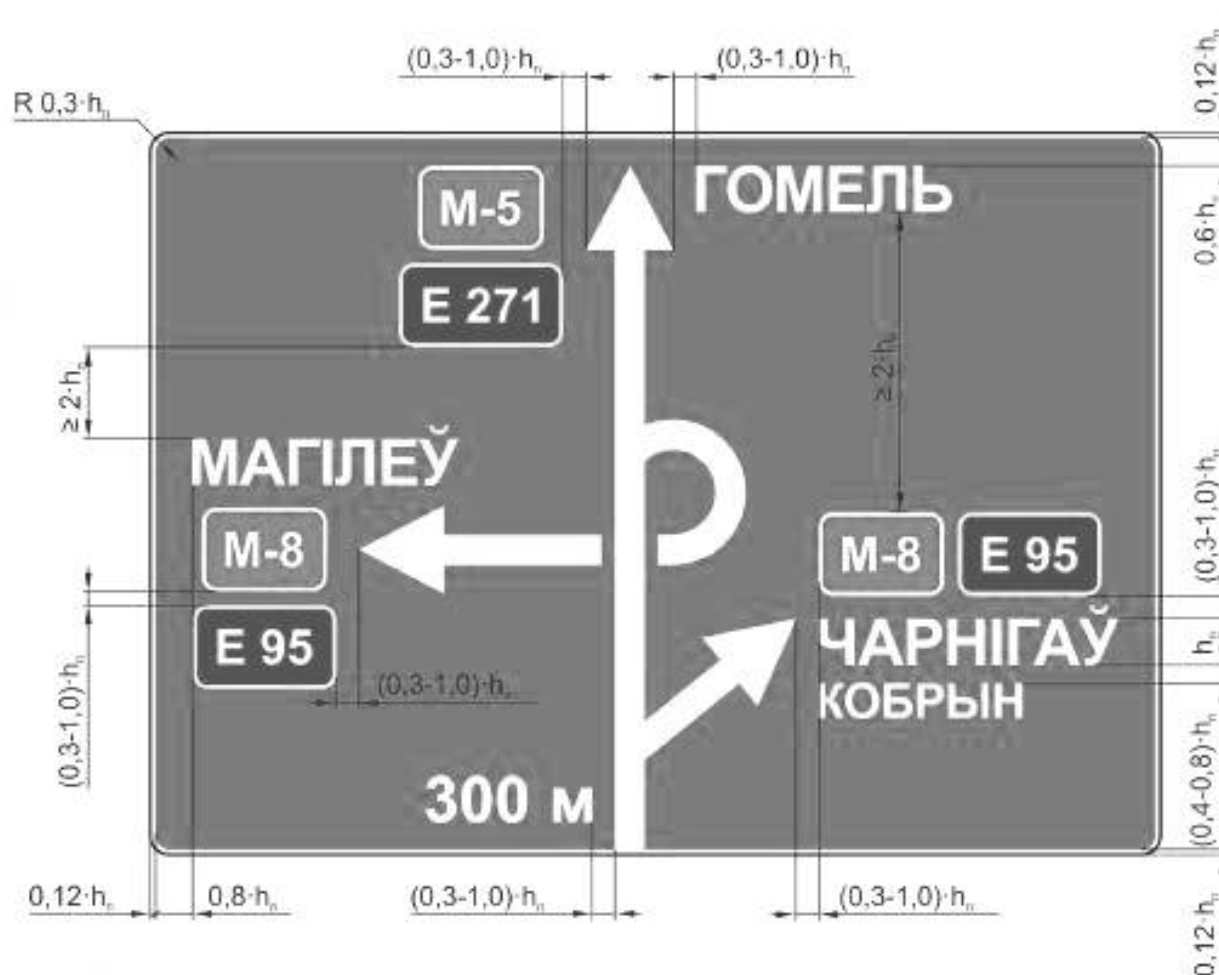
Рисунок В.1 — Пример компоновки изображения знака вида 27
