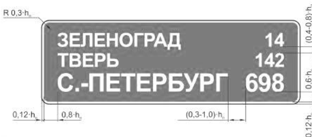
Рисунок В.5 — Пример компоновки изображений знака вида 36
