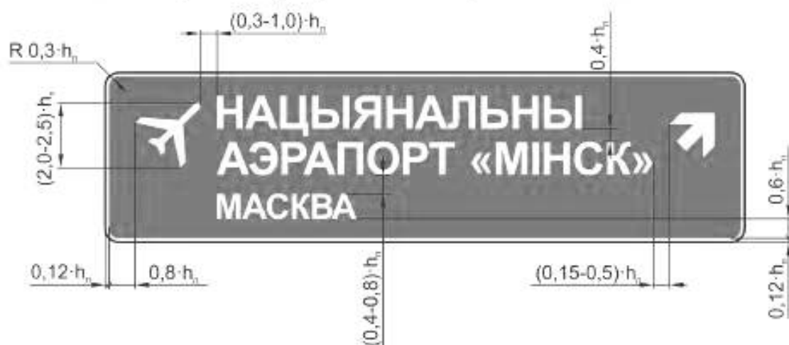
Рисунок В.2 — Пример компоновки изображения знака вида 29
