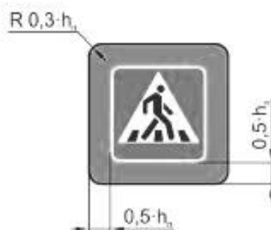
Рисунок В.10 — Пример компоновки изображения знака в форме квадрата, расположенного на фоновом щите желтого цвета
