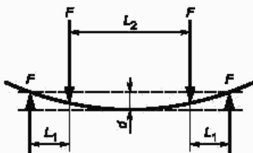
$L_1$  — расстояние между внешней опорой и ближайшей к ней внутренней опорой;  $L_2$  — расстояние между двумя внутренними опорами;  $F$  — сила (реакция опор), возникающая в каждой из опор, направленная перпендикулярно к испытуемому образцу в исходном состоянии (на большинстве приборов измеряют  $2F$ );  $d$  — изгиб (стрела прогиба) посередине испытуемого образца между внутренними опорами, измеренный от линии, проходящей через точки контакта внутренних опор с испытуемым образцом
