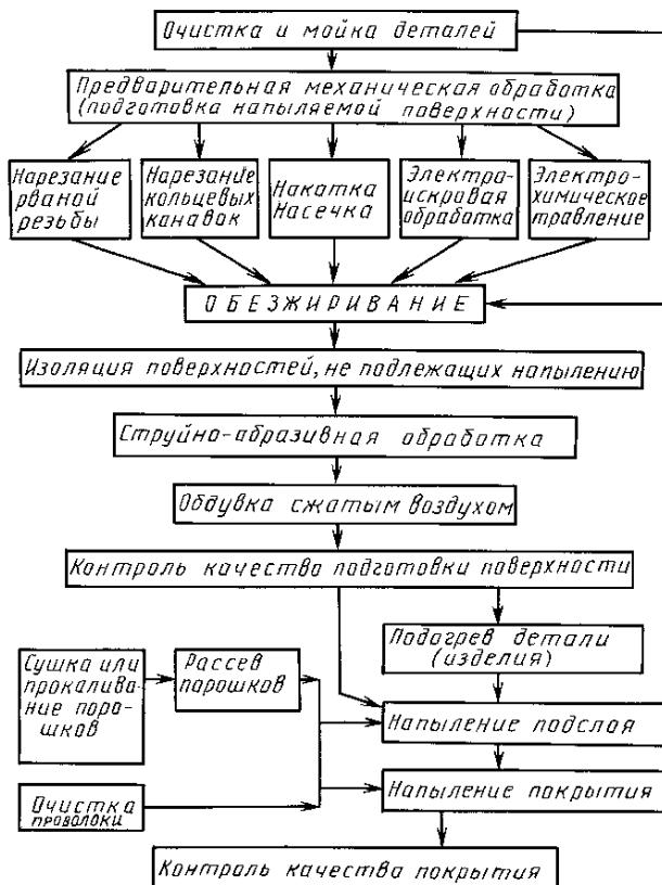
4.6. Поверхности деталей, не предназначенные к напылению, должны быть защищены экранами или накладками, а отверстия изолированы винтами или заглушками от воздействия абразивного материала при подготовке поверхности струйно-абразивным методом и от напыления.
