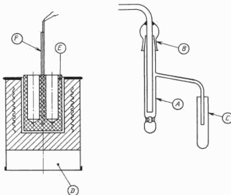
*A* – стеклянная пробирка для контейнера с образцом; *B* – круглый стеклянный шлиф; *C* – приемник;
