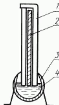
1 — пластинки хроматографической камеры; 2 — хроматограмма; 3 — лодочка хроматографической камеры; 4 — растворитель
