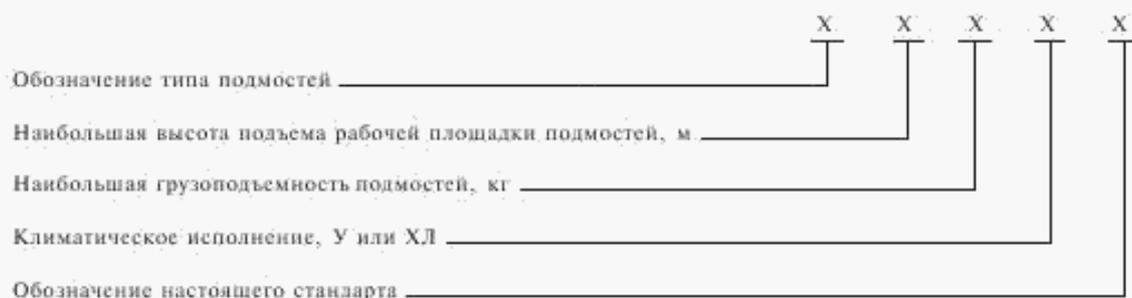
Пример условного обозначения шарнирно-рычажных подмостей с наибольшей высотой подъема 6 м, грузоподъемностью 300 кг, климатического исполнения У:
