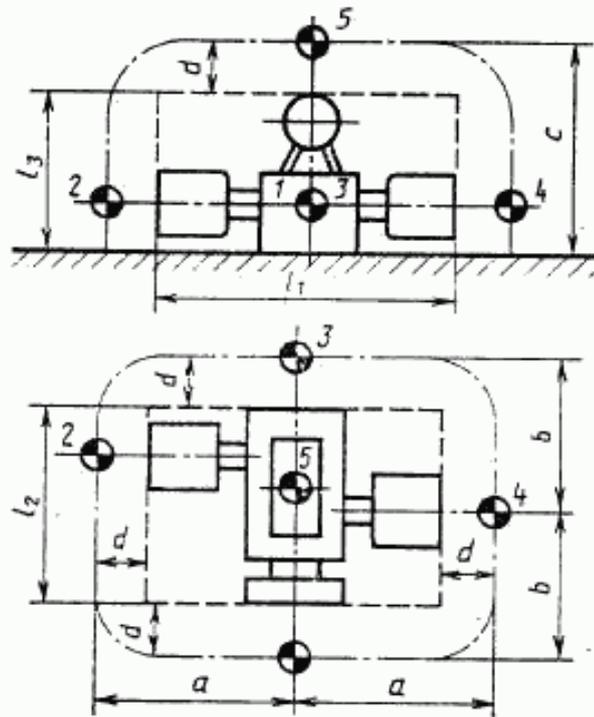
1—5 — измерительные точки;  $l_1$ ,  $l_2$ ,  $l_3$  — размеры компрессора;  $d$  — измерительное расстояние;  $a$ ,  $b$ ,  $c$  — размеры измерительной поверхности (см. ГОСТ 12.1.028—80)
