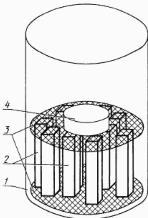
1 — химический стакан; 2 — образцы древесины для испытания; 3 — сетка; 4 — противовсплывное устройство
